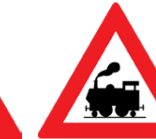
Bahnübergang ohne Schranken
