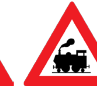
Bahnübergang ohne Schranken
